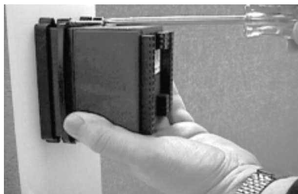
Figura 9.3c — Apriete de los tornillos.
